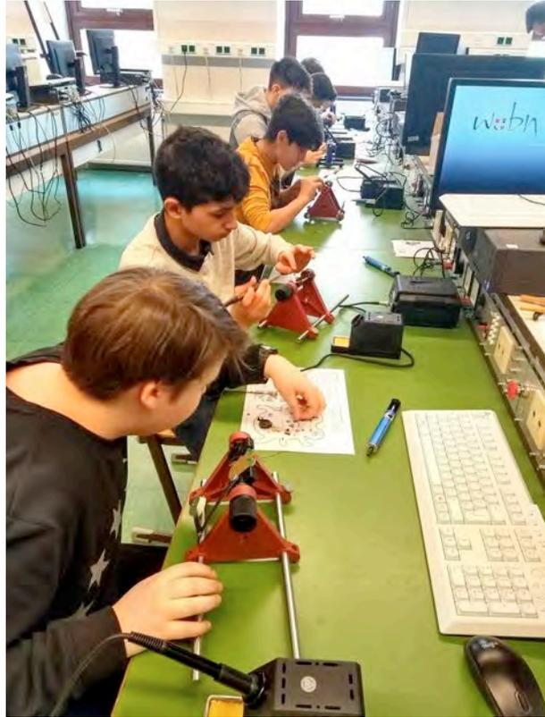
Abb. 13: Bestücken der Platine „Käfer“
