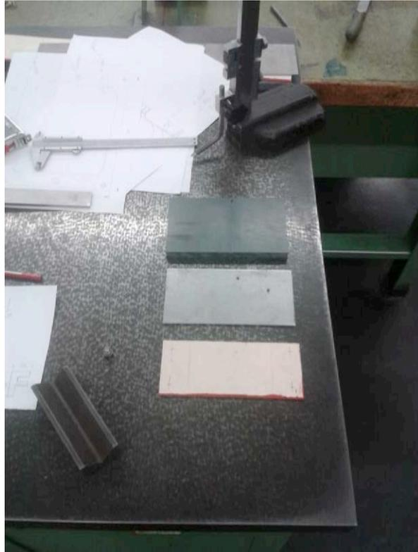
Abbildung 3: Abgelängte Rohmaterialien
